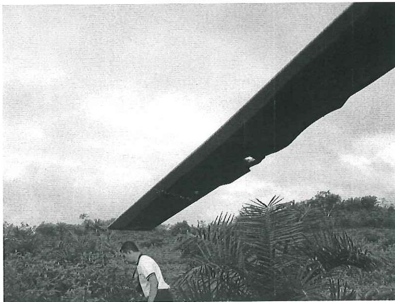
LAS PALAS DEL ROTOR PRINCIPAL SUFRIERON DAÑO TOTAL
